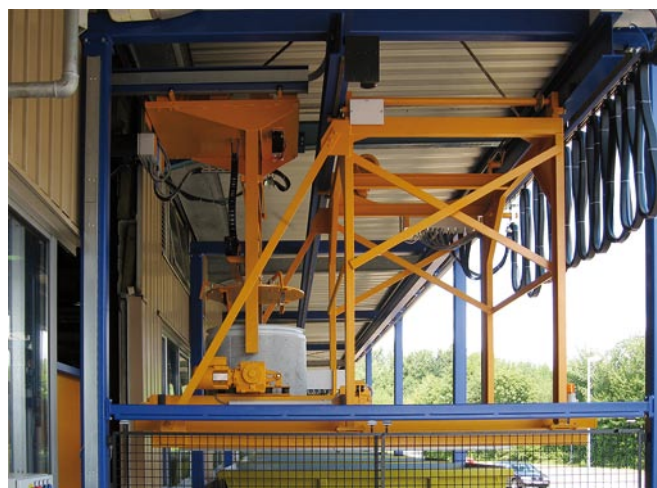
Chargement de bennes pour fixation au plafond
