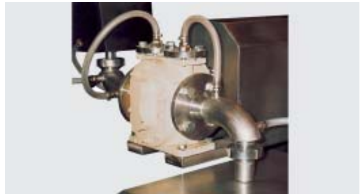
Pompe à engrenages TM avec corps à chauffage
