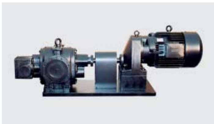
Groupe moto-pompe à engrenages avec corps à chemise chauffable et soupape, avec plaque d'assise, accouplement et moto-réducteur pour installations d'enrobage du bitume
