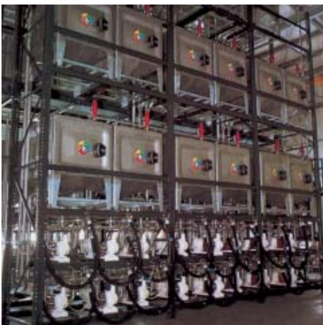
Pompes à engrenages et à pistons rotatifs pour les industries des peintures, de la chimie et de l'agroalimentaire
