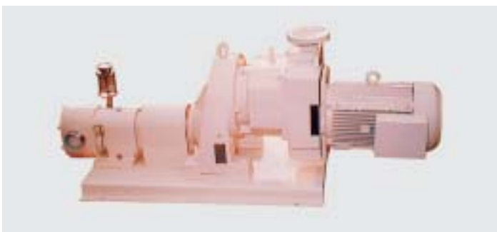
Groupe moto-pompe à pistons rotatifs avec moto-réducteur à friction à mécanisme ajustable et garniture mécanique d'étanchéité avec réserve de liquide à injection sans pression pour peintures et vernis solubles dans l'eau
