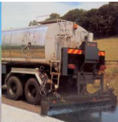
Epandeurs de liant à froid et véhicules avec épandeurs
