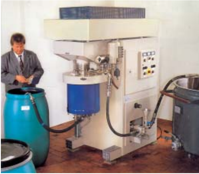
Pompe à engrenages dans un broyeur-malaxeur (Perf Mill)
