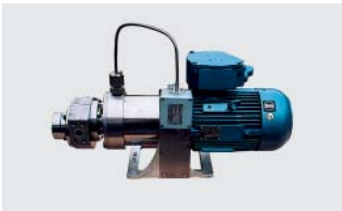
Pompe à engrenages avec accouplement à aimant (hermétique), moteur antidéflagrant, en acier moulé, avec sonde thermométrique (pétrochimie)
