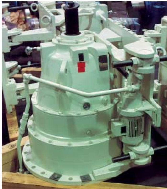
Pompe à engrenages SF pour graissage d'engrenages
