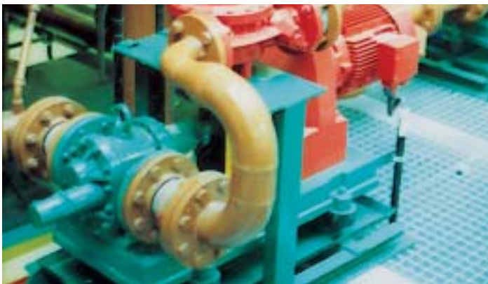
Pompe à engrenages T-GKGM dans une installation d'encre d'impression
